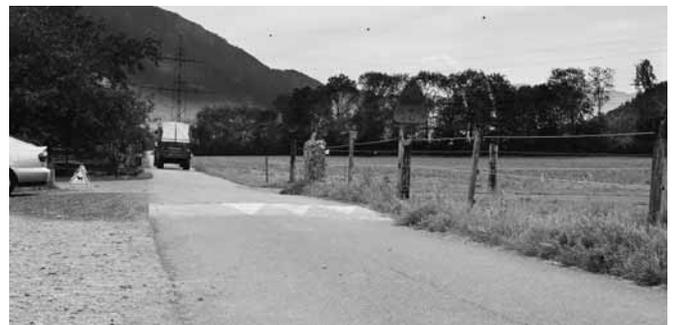
*Durch den Höhenversatz wird die Geschwindigkeit im Bereich des Hofes reduziert.*
